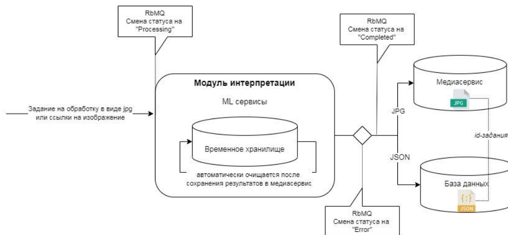
Рисунок 2. Схема работы модуля интерпретации
